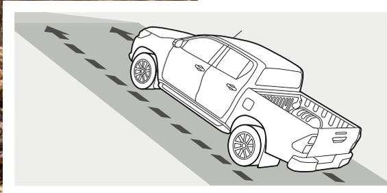
El Asistente de arranque en pendiente (HAC) mantiene la fuerza de frenado hasta dos segundos después de soltar el pedal de freno para ofrecer un arranque suave en pendientes inclinadas sin desplazarse hacia atrás.
