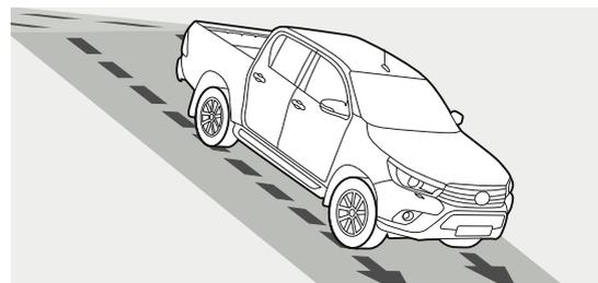
El Contro de descenso (DAC) te ayuda a enfrentar el descenso por una pendiente empinada con toda confianza. Aplica frenada individual para controlar la velocidad y mantener el vehículo estable, para que puedas centrarte en el volante y en esquivar obstáculos. Funciona también marcha atrás.
