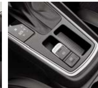
Freno de mano eléctrico con función Auto-Hold.
